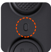
⑤ リモート接続インジケータ
